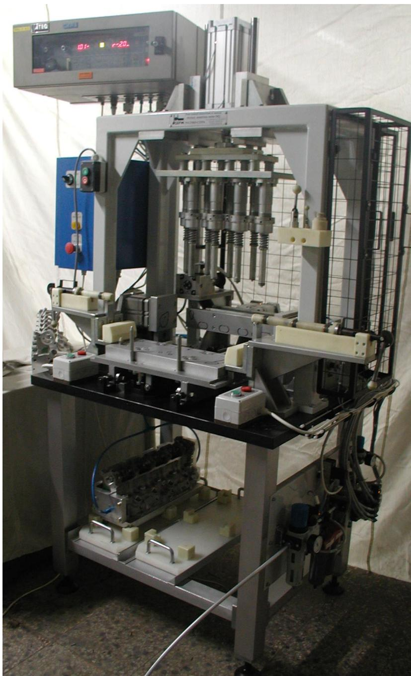
Instalație control etanșeitate și marcaj
