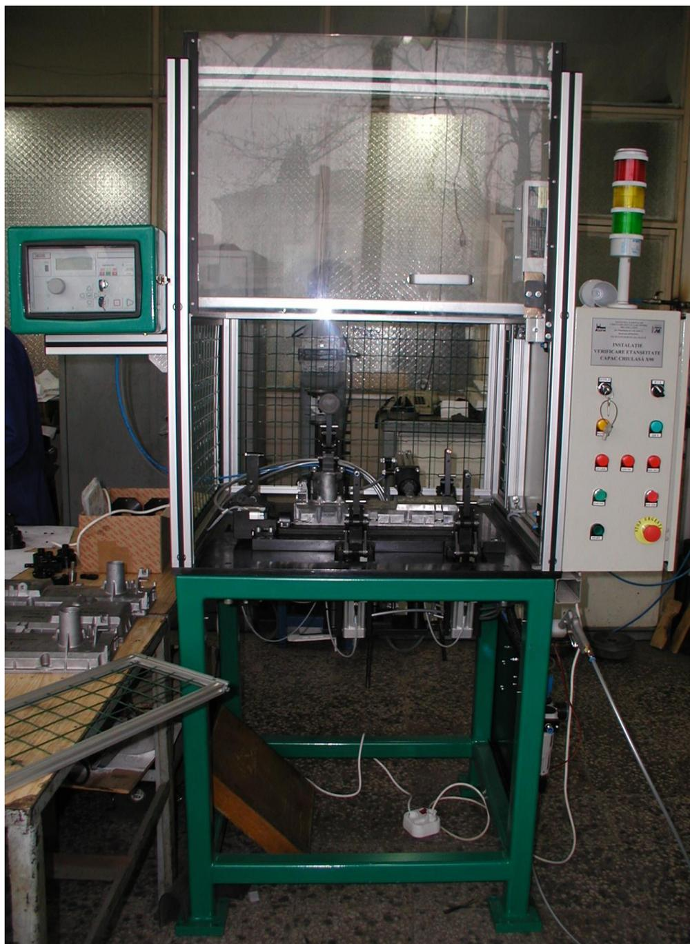
Instalație verificare etanșeitate
