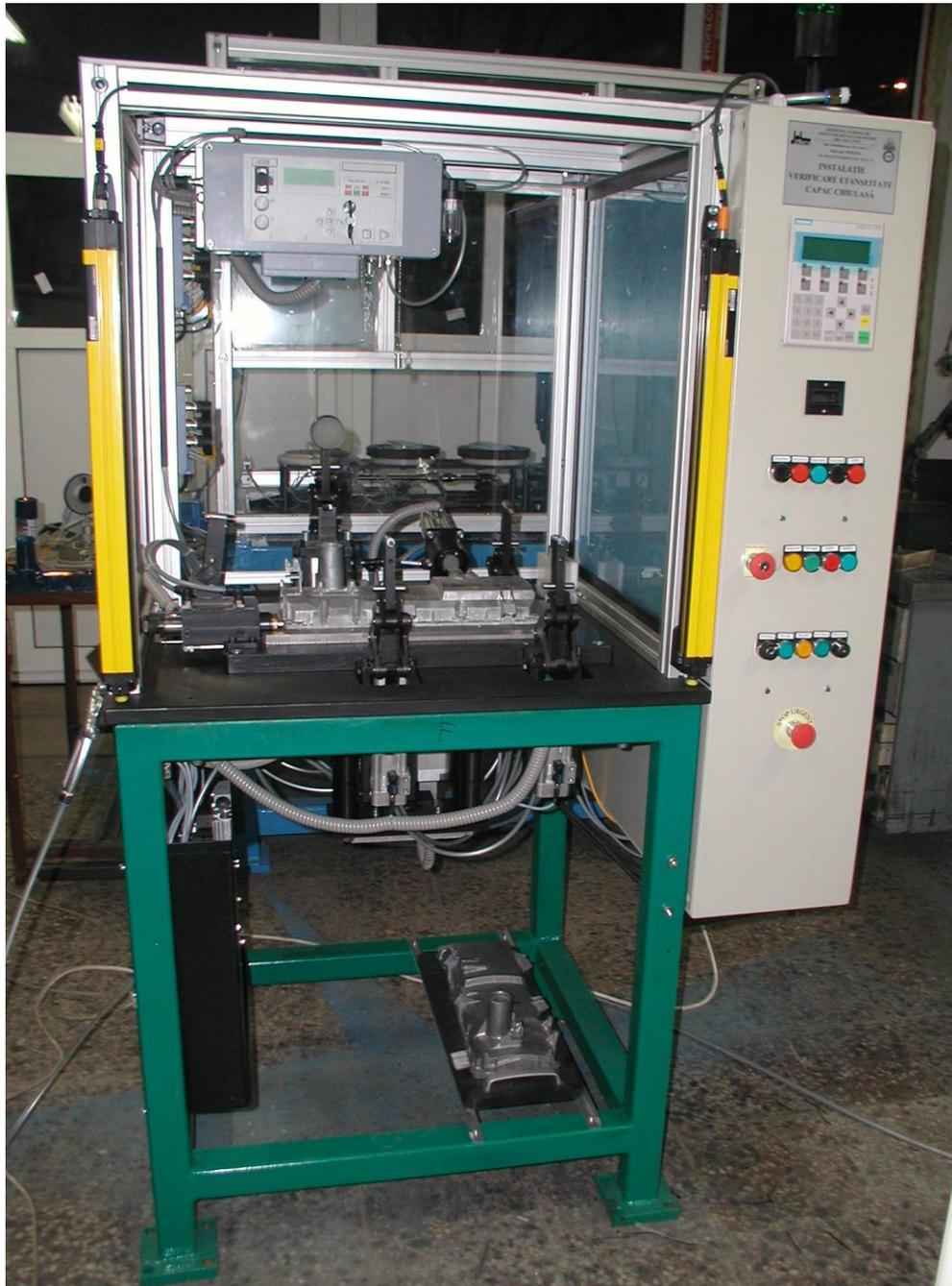
Instalație verificare etanșeitate capac
