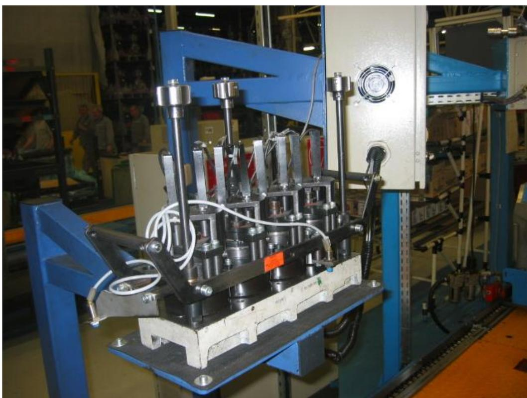
Instalație de verificat supraînălțarea
