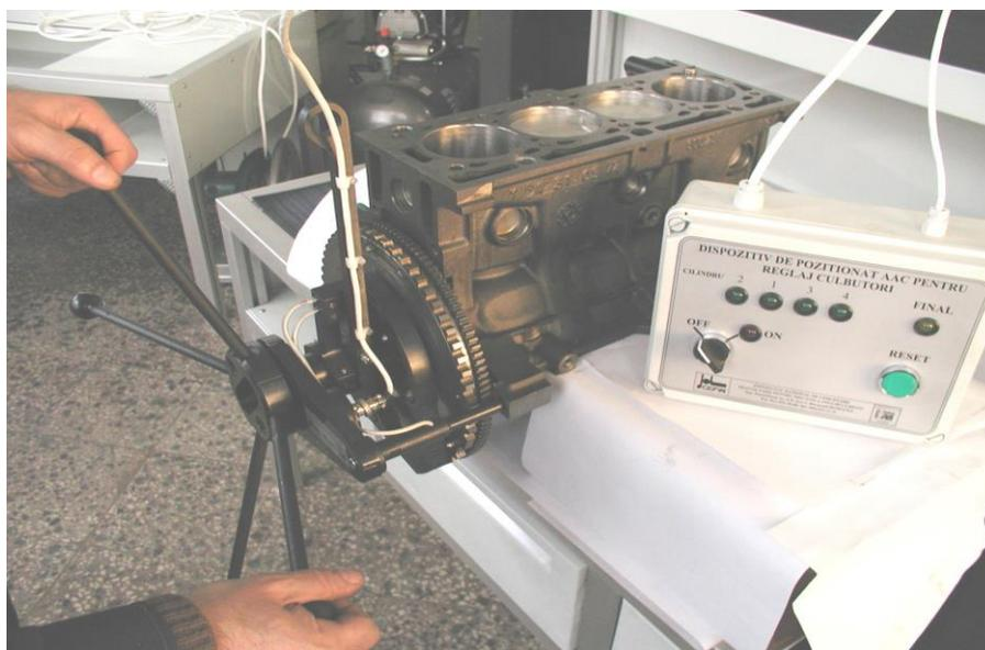
Dispozitiv rotire și poziționare arbore cu
