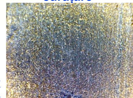
Mostra curățată cu parametrii II (f=65 kHz, Putere=30%)
