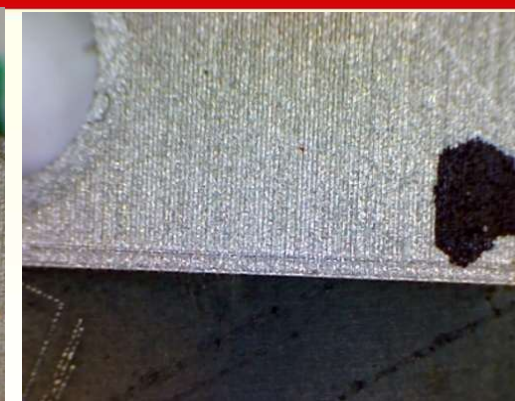
Comparație între suprafața curățată și cea inițială
