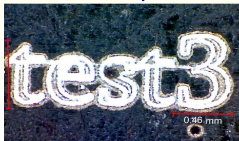
Marcare pe aluminiu eloxat negru
