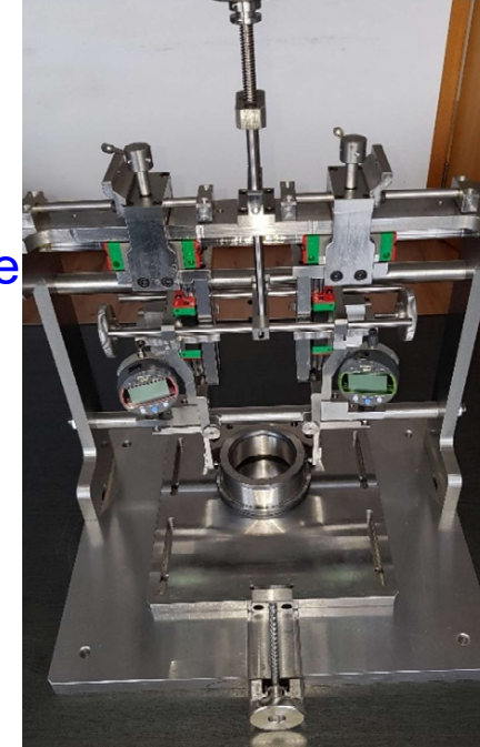
Dispozitiv pentru măsurarea diametrelor exterioare ale inelen de rulment
